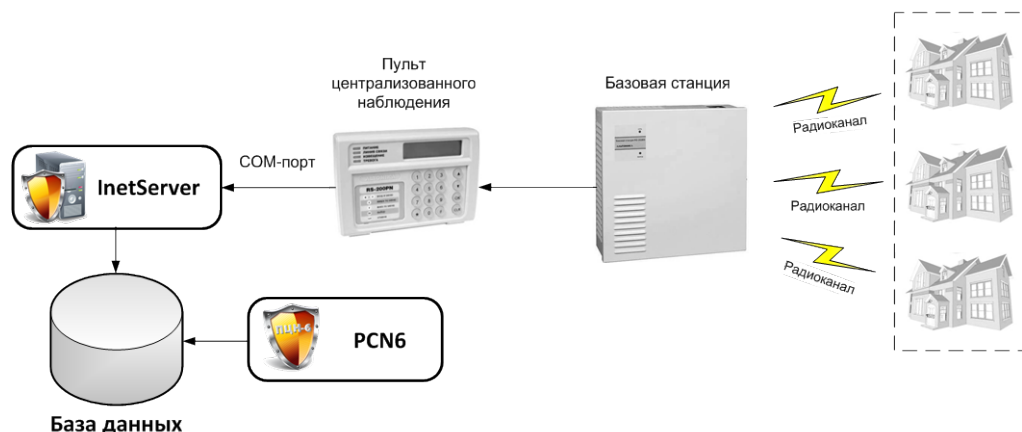
Рис. 3.3.18.1. Принцип работы потока «Альтоника RS-201PN и RS-202PN»
