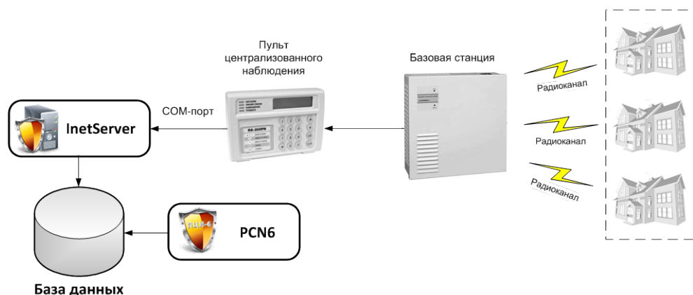
Рис. 3.3.18.1. Принцип работы потока «Альтоники RS-200PN»
