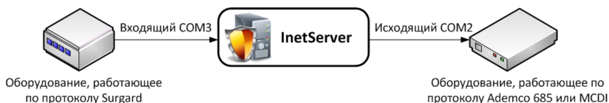
Рис. 3.3.3.1. Принцип работы потока «Преобразование протокола DSC Surgard»
