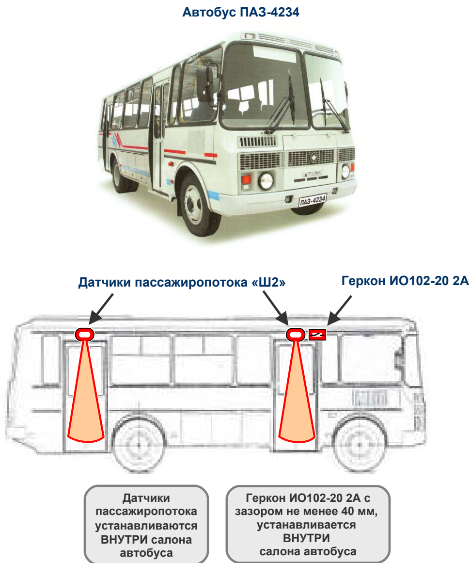
Рис.27.7. Пример установки датчиков пассажиропотока «Ш2» в салоне автобуса ПАЗ-4234
