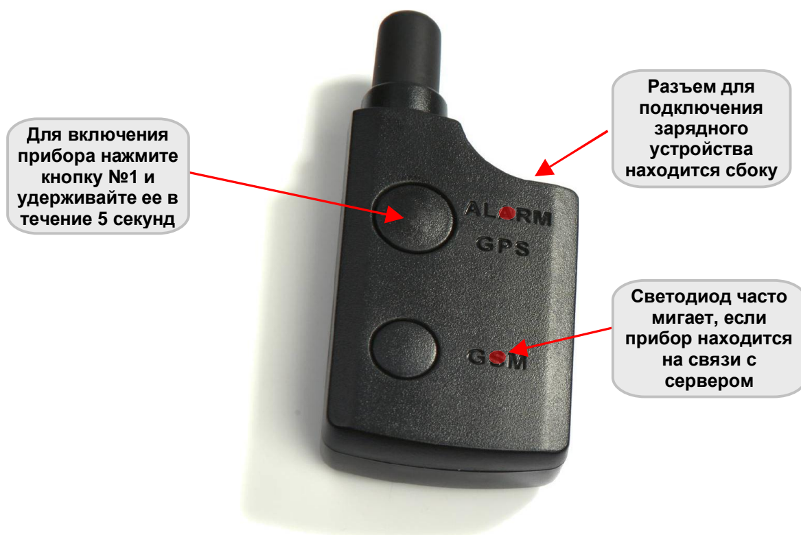
Рис.4.4. Включение «Контакт GSM-1»
