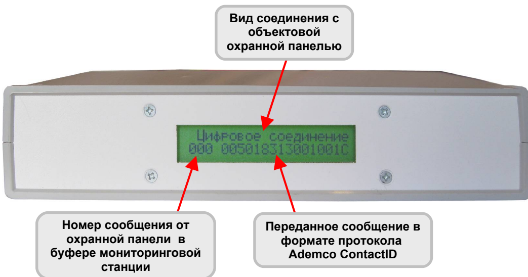
Рис.4.8. Вид соединения и сообщение от объектовой охранной панели в формате протокола Ademco ContactID на дисплее мониторинговой станции.
