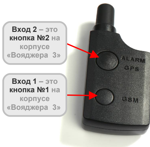
Рис.5.6. Расположение входов (кнопок) на корпусе «Вояджера 3».
