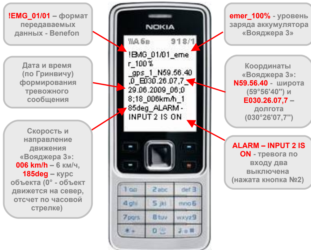
Рис.5.7. Пример тревожного SMS-сообщения, которое получает собственник при нажатии кнопки на корпусе «Вояджера 3».
