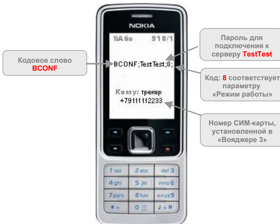
Рис.8.4. Пример запроса на чтение значения из памяти «Вояджера 3» – режима работы – с помощью SMS-сообщения.
