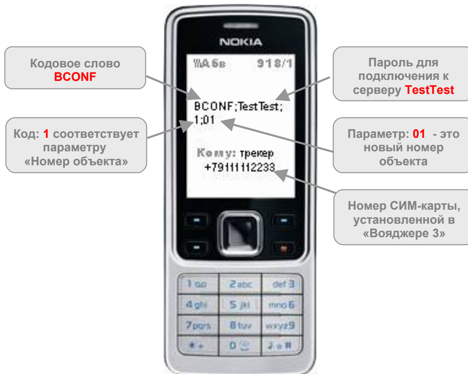
Рис.8.2. Пример настройки нового значения «Вояджера 3» – номера объекта – с помощью SMS-сообщения.
