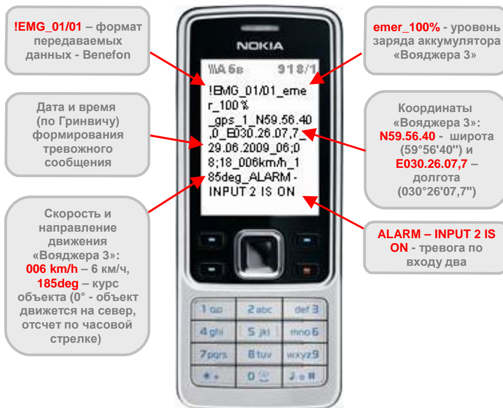
Рис.25.6. Пример тревожного SMS-сообщения, которое получает собственник при срабатывании «Вояджера» по входу 2.
