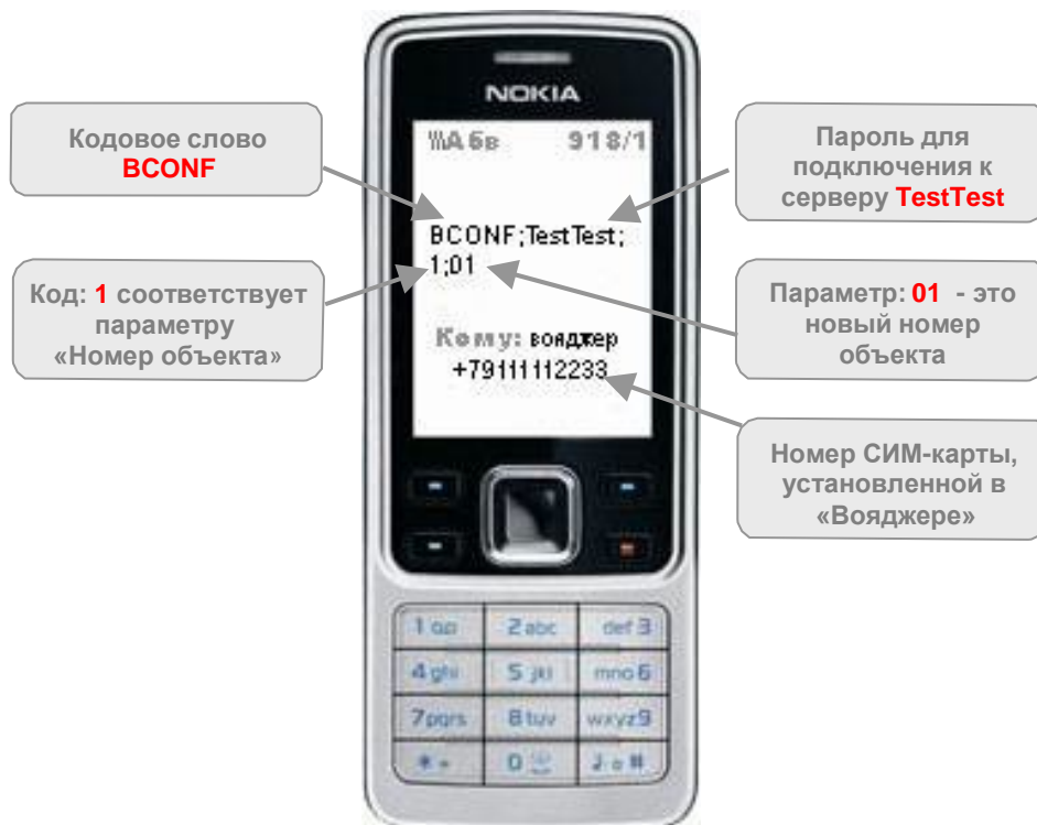
Рис.25.2. Пример настройки нового значения «Вояджера» – номера объекта – с помощью SMS-сообщения.
