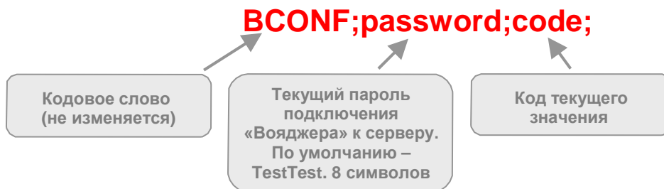
Рис.25.3. Формат SMS-сообщения для чтения значений параметров.
