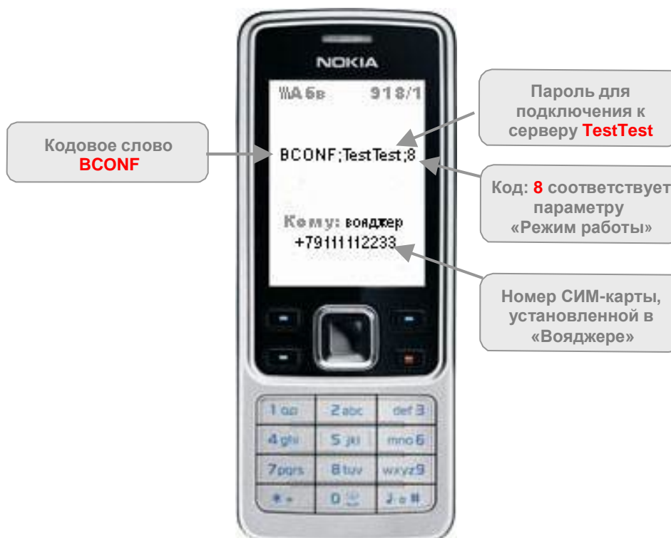
Рис.25.4. Пример запроса на чтение значения из памяти «Вояджера» – режима работы – с помощью SMS-сообщения.
